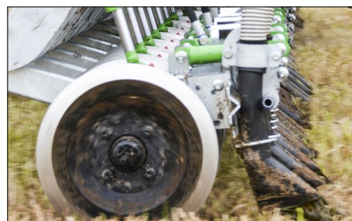
Nieuwe bevestiging van de slang in de injectie- mondstuk en nieuwe hydraulische afknijpers
